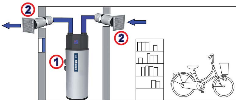
Figura 2 1 Pompa di calore energy energy heat pump Pompe à chaleur energy Wärmepumpe energy 2 Griglia di aspirazione/espulsione GE160 GE160 intake/exhaust grill Grille d'extraction/rejet GE160 Ansaug-/Ausblasgitter GE160
